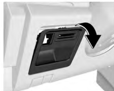
Caja de fusibles interior
